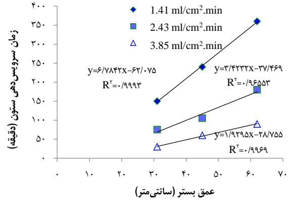
شکل ۱. زمان کارکرد ستون‌های جاذب GAC (بر حسب تغییرات عمق ستون) (Granular activated carbon)
